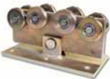
VO555 kyvný nosný vozík, pouzdrěná ložiska, zinkovaný, nosnost 600 kg
