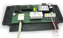
SBM 250 řídící jednotka ovládaná mobilními telefony
